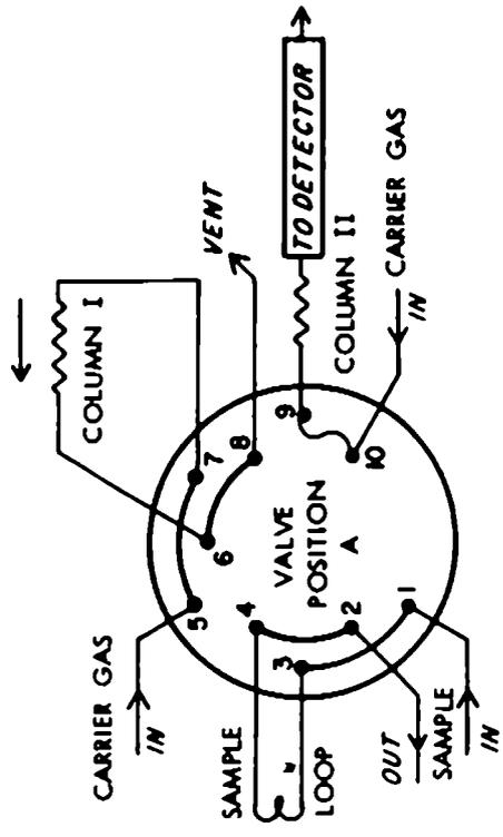
(A) LOADING/BACKFLUSHING MODE
